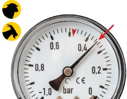
Mindkét esetben ügyeljen, hogy a vákuum szintje ne haladja meg a -0,5 bar-t! Ha a vákuumszint nem megfelelő, a gépen található vákuumsabályzóval állíthatja.
