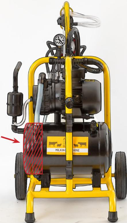
Nivelul optim de ulei este de aproximativ 30% din înălțimea totală a rezervorului.
