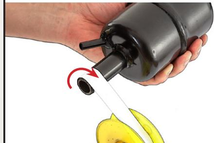
Înșurubați filtrul de evacuare în cotul de pe rezervorul de ulei de vid. Poziționați ieșirea filtrului astfel încât să nu incomodeze operatorul sau animalele în timpul mulsului.
