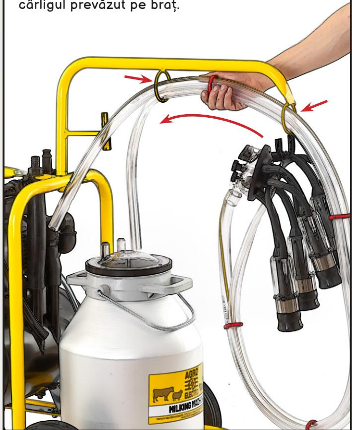
Conectați furtunul(furtunurile) de lapte care vine(vin) de la grupul(grupurile) de muls (pe cel gros) la capacul bidonului, având grijă să nu folosiți raccordul unde este montat opritorul de lapte!
