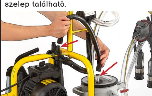
A vákuumórát óvatosan helyezze a gépen kialakított helyére.
