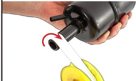
Навийте изпускателния филтър в коляно на вакуумния резервоар за масло. Нагласете изхода на филтъра така, че да не пречи на оператора или животните по време на доенето.
