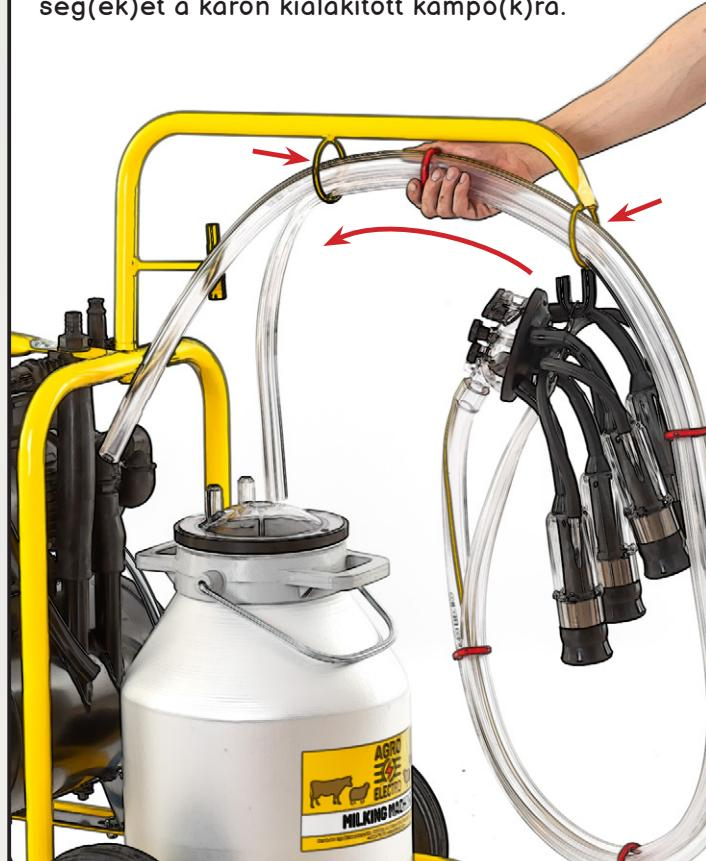
A fejőegység(ek)ből érkező tejtömlő(ke)t (a vastagabbat) csatlakoztassa a sajtár fedelére, de ne arra a bemenetre, amelyen a labdás szelep található!
