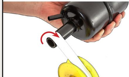
Avvitare il filtro di scarico nel raccordo del serbatoio dell'olio a vuoto. Posizionare l'uscita del filtro in modo da non disturbare l'operatore o gli animali durante la mungitura.
