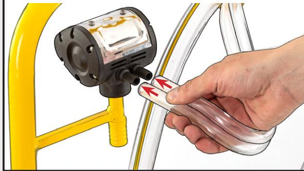
A vákuumelosztón található vasstag tömlő(ke)t csatlakoztassa a pulzátor(ok) konzoljához.
