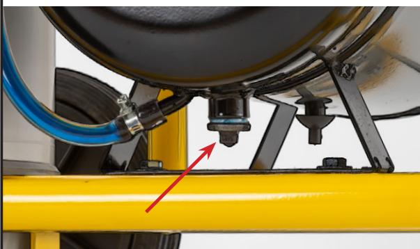
Az olaj feltöltése vagy utánpótlása az olajtartályt és a szi-vattyút összekötő vastag tömlőn keresztül lehetséges – a tömlő felső csatkozását meg kell bontani és egy tölcséren keresztül tölthető be az olaj.
