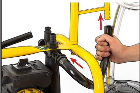
Collegare il bidone all'apparecchio. Sul coperchio del bidone, collegare il tubo flessibile al raccordo dove si trova la valvola a sfera.
