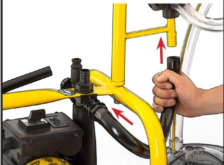
Kötse össze a sajtárt és a gépet. A sajtár fedelén a tömlőt arra a bemenetre rögzítse, amelyen a labdás szelep található.
