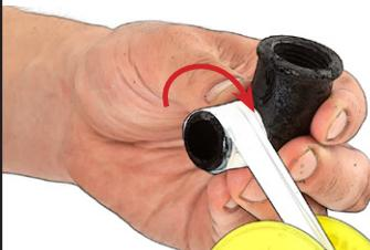
Sigillare la filettatura del filtro di scarico con nastro di teflon o stoppa.
