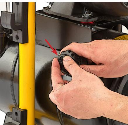
Ajustați poziția regulatorului până când atingeți nivelul optim de vid. În timpul reglajului, eliberați periodic regulatorul, deoarece atingerea acestuia poate influența reglarea vidului.
