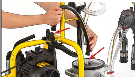
Posizionare con cautela il manometro del vuoto nell'apposita cavità per l'apparecchio.
