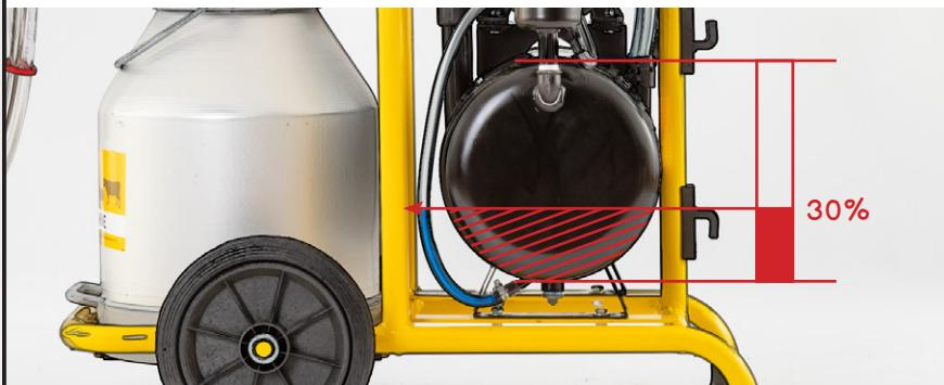
Il livello dell'olio può essere controllato attraverso il sottile tubo flessibile trasparente che collega il serbatoio alla pompa.
