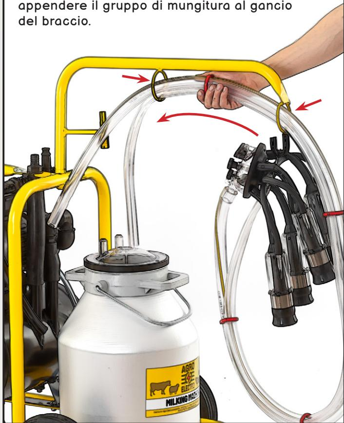
Collegare il/i tubo/i del latte proveniente/i dal gruppo/i di mungitura (quello spesso) al coperchio del bidone, facendo attenzione a non utilizzare il raccordo dove è montata la valvola del non ritorno del latte!
