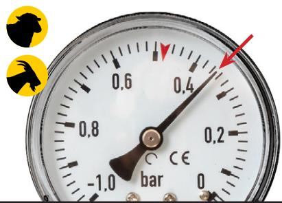
În ambele cazuri, asigurați-vă că nivelul de vid nu depășește -0,5 bar! Dacă nivelul de vid nu este corespunzător, îl puteți regla folosind regulatorul de vid montat pe aparat.
