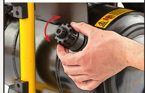
След приключване на регулирането затегнете здраво фиксиращата гайка, без да позволявате на врътката да се размести.
