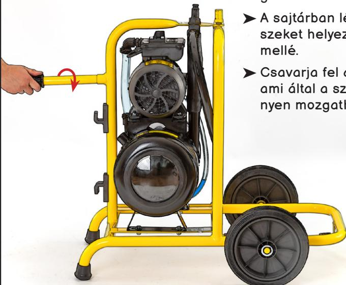
Az összeszerelés során ajánlott 20 °C fölötti hőmérsékleten dolgozni, a tömlők könnyű illeszthetőségének céljából. Ha a tömlők nehezen illeszthetők, nedvesítse be a belsejüköt vízzel, vagy melegítse meg óvatosan a végüköt hőlégfújóval.
