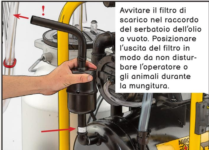
Collegare il tubo flessibile proveniente dalla pompa del vuoto al filtro di scarico.
