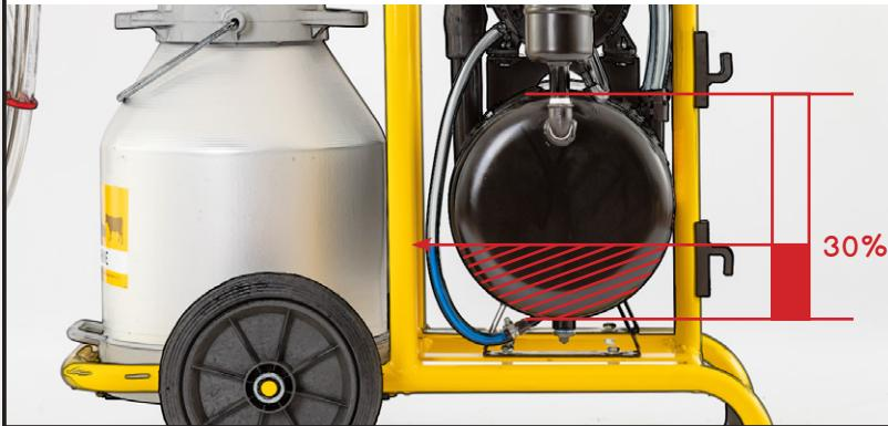
Az olajszint az olajtartályt a szivattyúval összekötő átlátszó vékony tömlőn keresztül ellenőrizhető.
