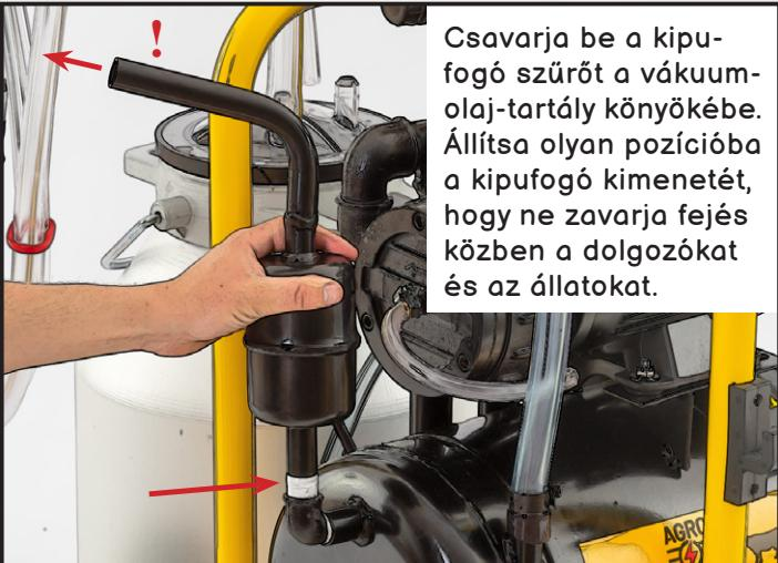
Csatlakoztassa a vákuumpumpából jövő tömlőt a kipufogó szűrőhöz.
